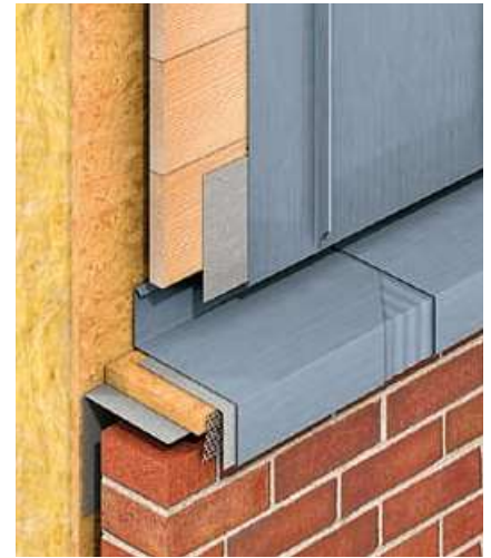
Fig. 18: UDS-Connector for a cornice coping
