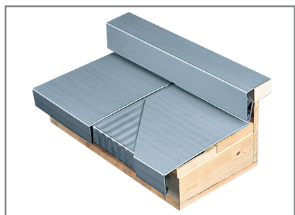
Doorsnee op verbingsstuk van een daklijst
